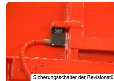
Sicherungsschalter der Revisionstür im Einfülltrichter
