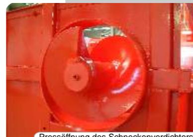
Pressöffnung des Schneckenverdichters mit stabiler, konischer Schnecke
