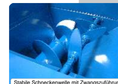
Stabile Schneckenwelle mit Zwangszuführung
