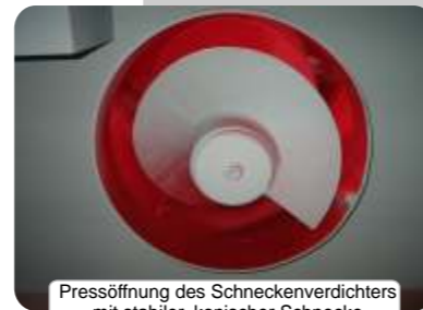
Pressöffnung des Schneckenverdichters mit stabiler, konischer Schnecke
