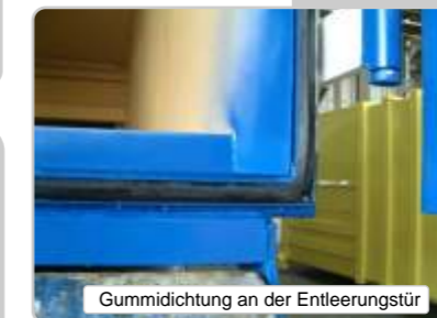
Gummidichtung an der Entleerungstür
