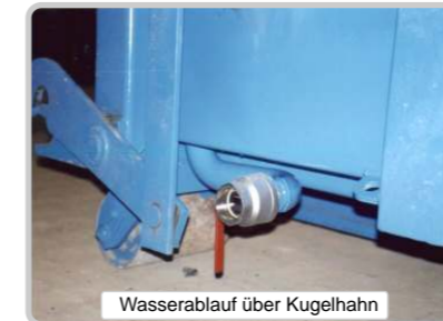
Wasserablauf über Kugelhahn
