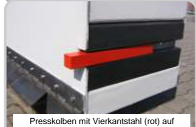
Presskolben mit Vierkantstahl (rot) auf Polyamiden (schwarz) und Stahlabstreifern
