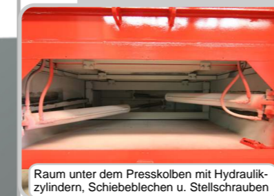
Presskolben mit Vierkantstahl (rot) auf Polyamiden (schwarz) und Stahlabstreifern
