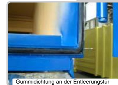
Gummidichtung an der Entleerungstür
