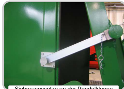
Sicherungssätze an der Pendelklappe
