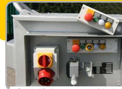
Standard Bedientastatur zusätzlich mit Fernbedienung und 75 % Vor-Vollmeldung
