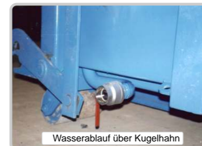
Wasserablauf über Kugelhahn
